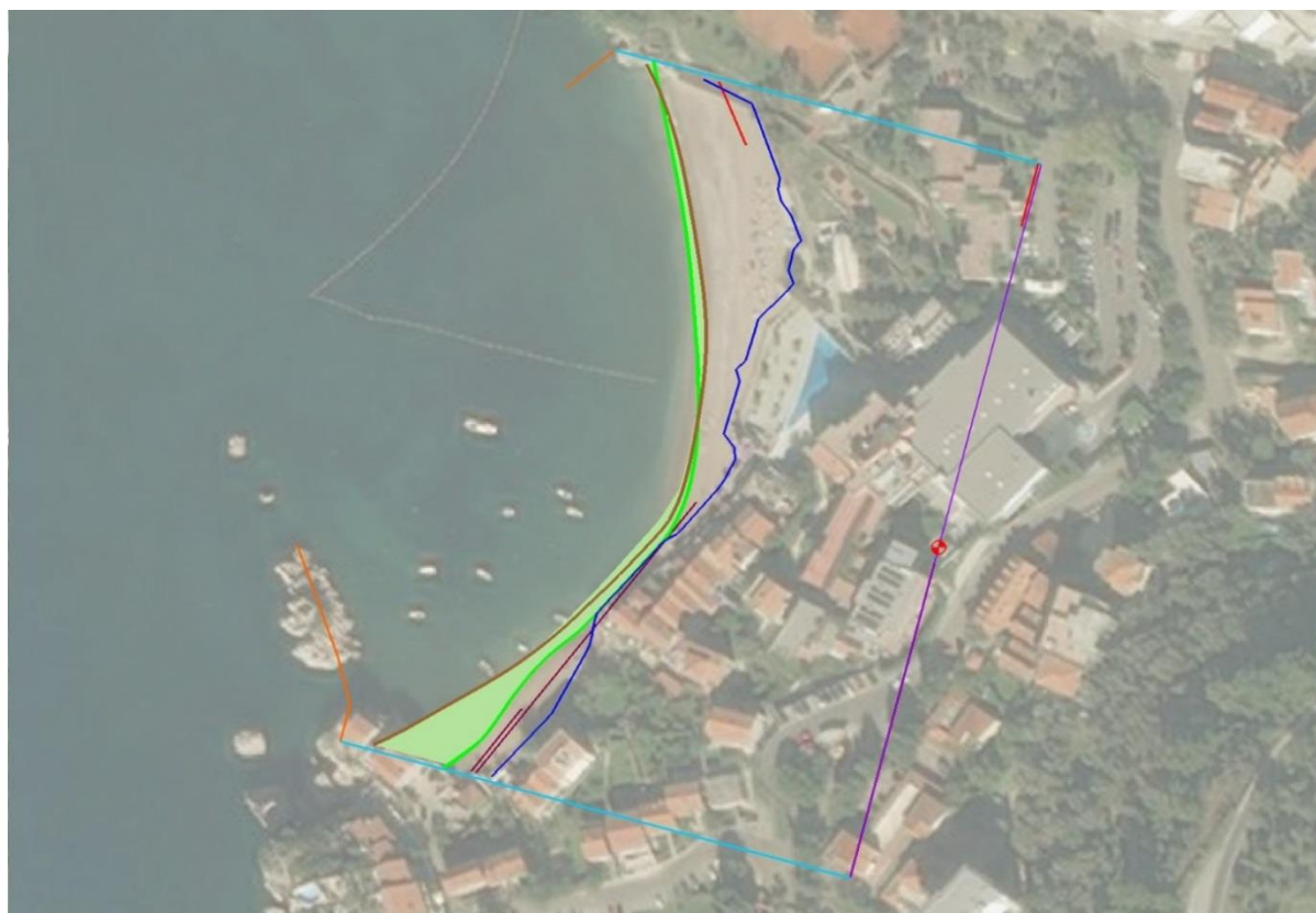
Slika 5.107. Prikaz anvelope položaja obalne linije u razdoblju od 04. 08. 2009. do 13. 01. 2010. godine za varijantu s nasipanjem
