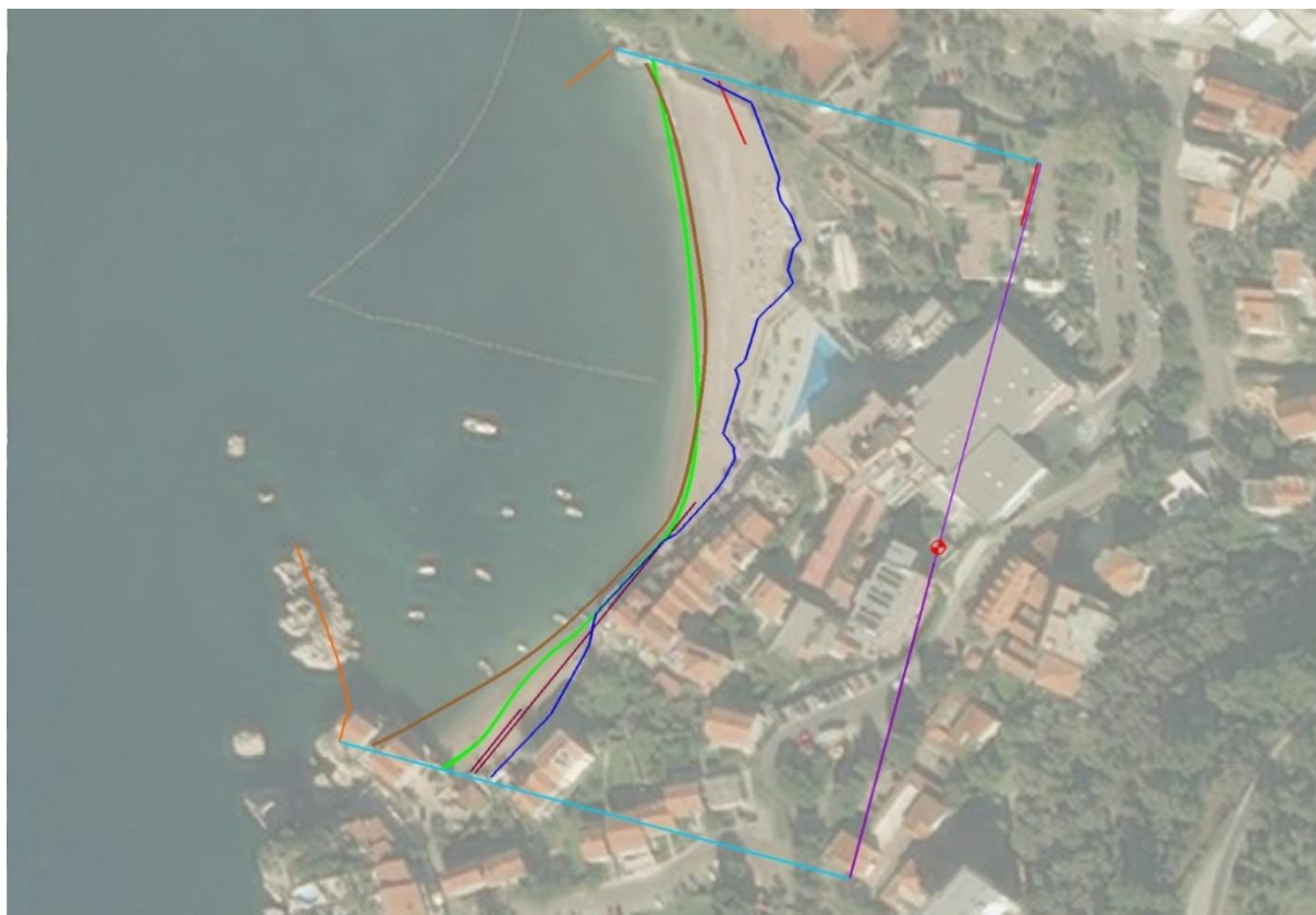
Slika 5.106. Rezultat oblika lica plaže na datum 13. 01. 2010. godine za varijantu s nasipanjem
