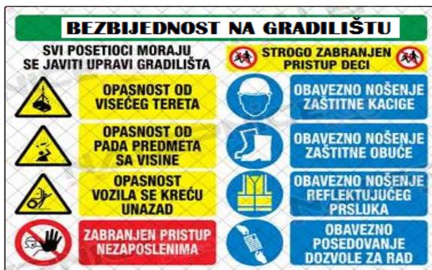
Slika 7. Znaci i upozorenja koji se moraju postaviti na ulazu u gradilište
