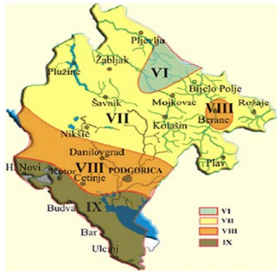
Slika 5. Karta očekivanih maksimalnih magnituda zemljotresa u Crnoj Gori i okruženju za povratni period vremena od 100 godina
